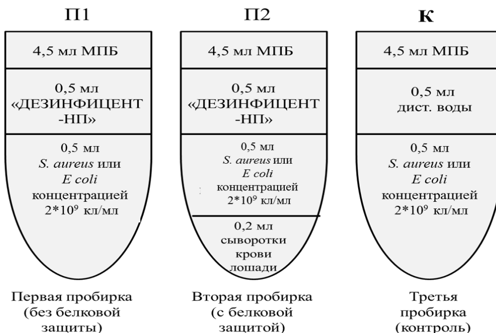
Рисунок 1 – Схема опыта по определению бактерицидного и бактериостатического действия 0,5 мл «ДЕЗИНФИЦЕНТ-НП» с применением тест-культур Escherichia coli ATCC 25922 и Staphylococcus aureus ATCC 6538-P FDA 209-P
