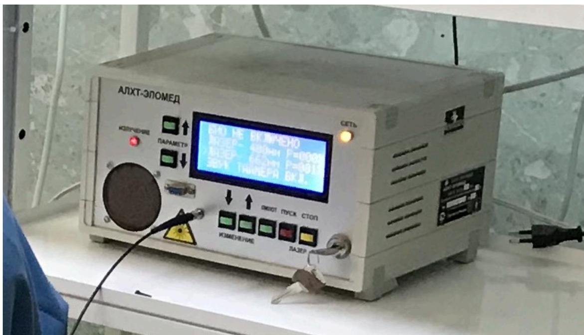
Рисунок 2.5 – Источник лазерного облучения аппарата АЛХТ-ЭЛОМЕД для ФДТ
