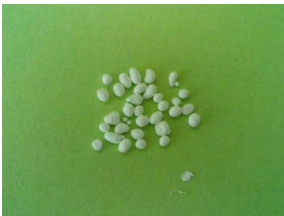
Рисунок 5 - Частицы полимерной суспензии
