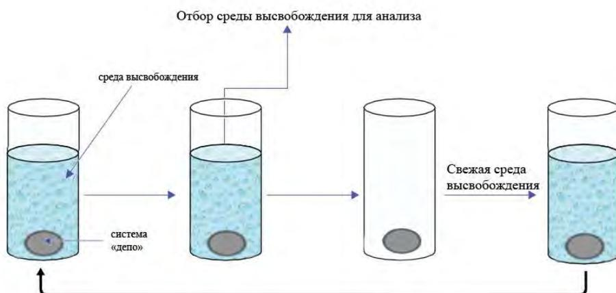
Рисунок 6 - Метод Sample-separation
