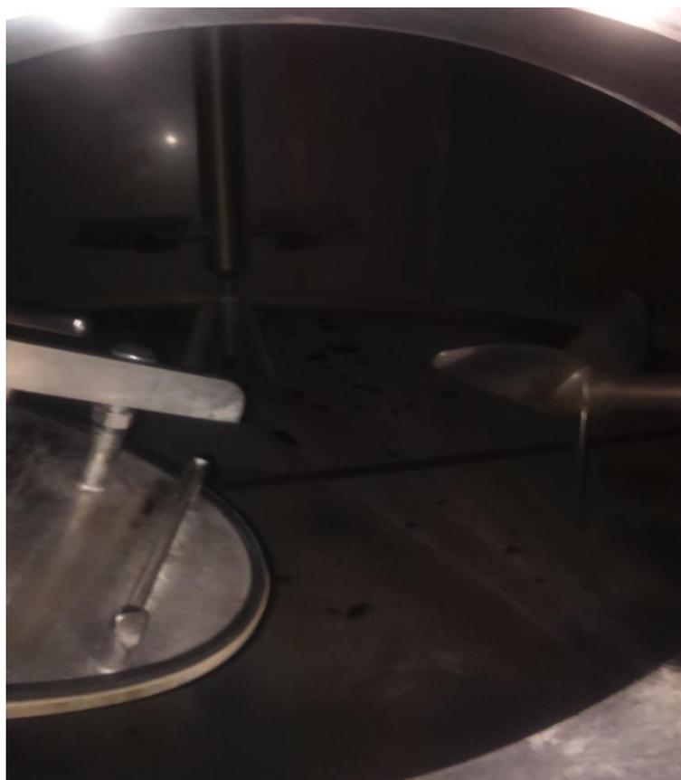
Рисунок 3. Емкостное оборудование участок приготовления нормализованных смесей АО «Вимм-Билль-Данн» до мойки
