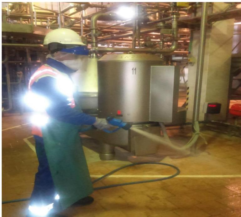
Рисунок 3. Влажная дезинфекция участок приготовления нормализованных смесей АО «Вимм-Билль-Данн»
