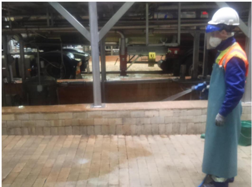
Рисунок 2. Влажная дезинфекция участок приготовления нормализованных смесей АО «Вимм-Билль-Данн»
